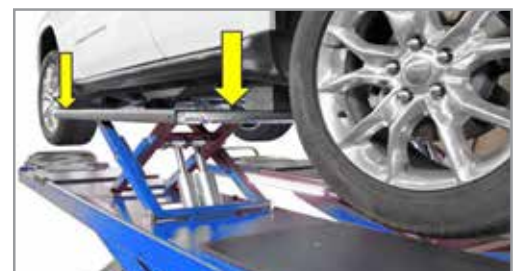
La table élévatrice a une double extension: une à l'avant et une à l'arrière. The lift table has a double extension: one on the front and one on the rear.
