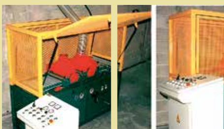
Safety: Optional cage (required in EC) Jaula de seguridad opcional (obligatoria en Europa)
